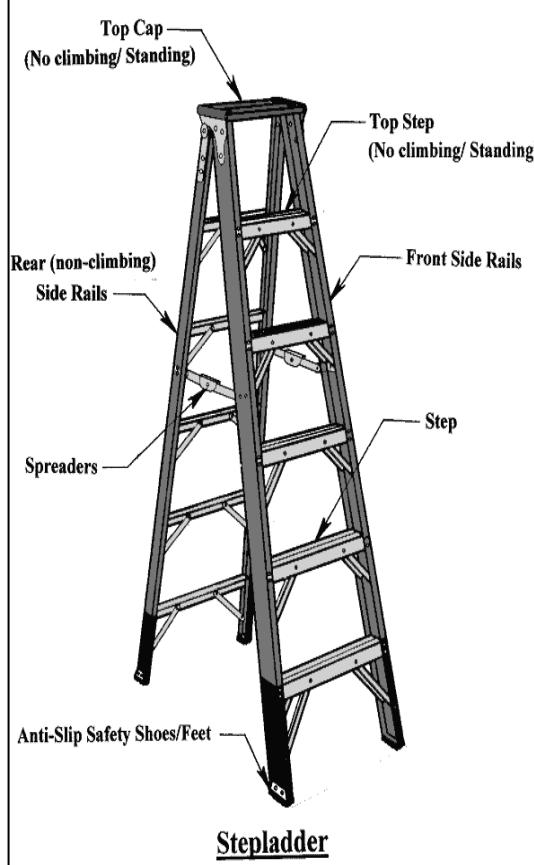
1) Escoja la escalera del tamaño correcto para el trabajo. Asegurese que la altura maxima del trabajo esta establecida y compruebe la capacidad de carga de la escalera. Use solamente escaleras apropiadas (no-conductoras) cerca de los conductores eléctricos.
